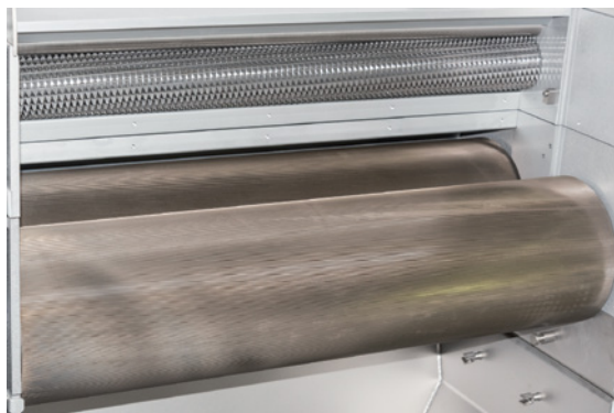
Rulli con rivestimento in titanio.
