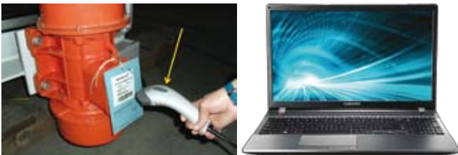
После локализации требуемой упаковки монтажник с помощью лазерного пистолета, подключенного к ноутбуку, может определить точное положение позиции на технологической схеме
