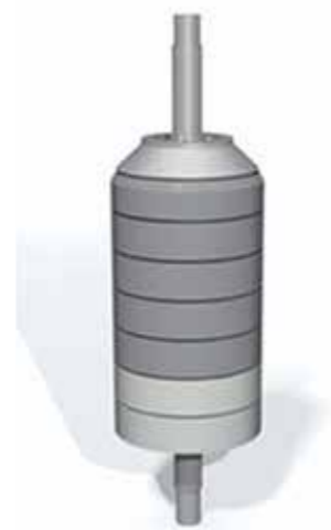
Figura 2 - Rappresentazione in 3D del pacco mole utilizzato per le prove, con le due mole diamantate sul fondo
