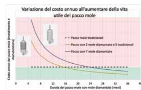
Figura 8 - Costo annuo equivalente del pacco mole al variare della vita utile: determinazione della durata di pareggio (break-even point) per due soluzioni alternative
